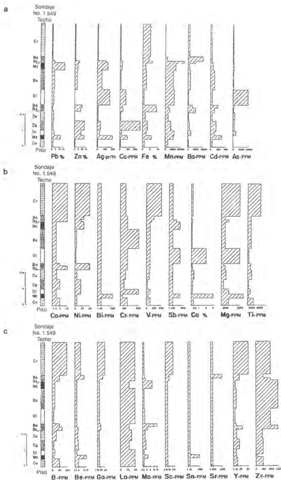
FIG. 4. Los gráficos a-c ilustran los contenidos geoquímicos de la sección estratigráfica mineralizada de la figura 3. Se indican, del piso al techo, los tipos litológicos analizados: Cu: cuarcita, Mz: maciza, Di: diseminada, Cg: conglomerado (cementación), Bx: en brechas, Ba: bandeada, Cr: corneana.
